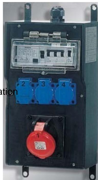
Gifas Electric Vollgummi-Wandverteiler 73102CPO5 CEE-Steckdose - 16 A 1x16A5p400V, CEE-Steckdose - 32 A 1x32A5p400V, CEE-Steckdose - 63 A ohne, CEE-Steckdose - 125A ohne, Anzahl der SCHUKO-Steckdosen 2, Absicherung LS-Schalter, FI-Schutzschalter ohne, Werkstoff des Gehäuses Gummi, Einspeisung/Anschlussmöglichkeit 1 Leitung (Stichleitung), Art des Netzanschlusses M25, Handhabung Wandmontage, Schutzart (IP) IP54, Farbe schwarz,
