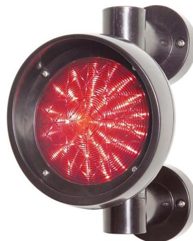
Berner Torantriebe LED-Ampel TL40RD Nennspannung 230V, Stromart AC, Schutzart (IP) IP65, Werkstoff des Gehäuses Kunststoff, Leistung 10W, Fassung sonstige, Leuchtmittel LED, Anzahl der Leuchtfelder 1, Durchmesser Optik 125mm, LED-Ampel rot, 230 V, einschl.
