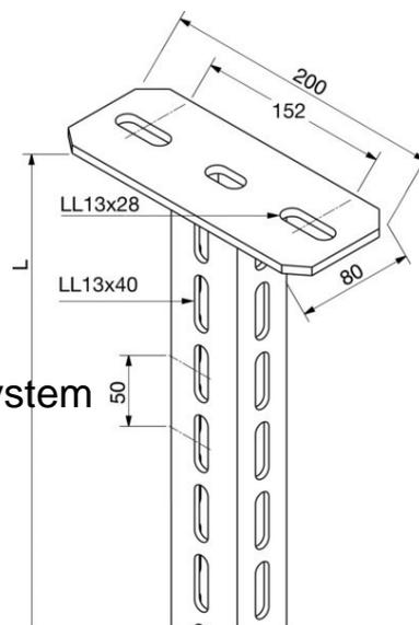
Rico Hängestiel 16A9-700 Länge 700mm, Profilbreite 60mm, Profilhöhe 40mm, Ausführung U-Profil, Tragfähigkeit 6kN, Werkstoff Stahl, Werkstoffgüte sonstige, Oberfläche tauchfeuerverzinkt, Farbe ohne,
