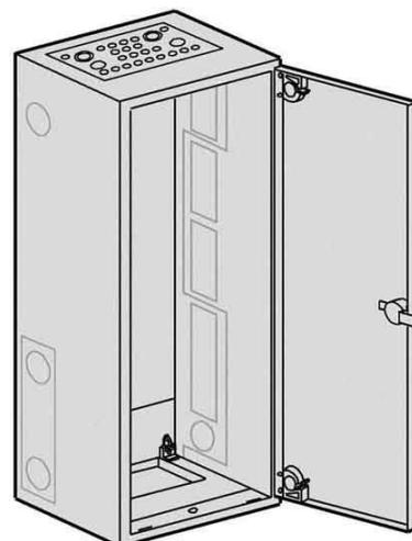
ABN Braun System-Gehäuse S 15 Montageart Aufputz/Unterputz/teilversenkt, Werkstoff Stahlblech, Schutzart (IP) IP43, Breite 300mm, Tiefe 210mm, Mit Leitungseinführungsmembrane.
