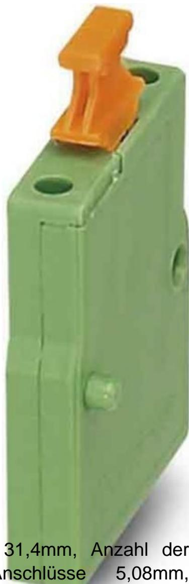
Phoenix Contact Leiterplattenklemme PTS-5,08 Höhe 31,4mm, Anzahl der elektrischen Anschlüsse 1, Rastermaß der Anschlüsse 5,08mm, Bemessungsstrom In 12A, Bemessungsspannung 320V, Bemessungsstoßspannung 4kV, Überspannungskategorie III, Verschmutzungsgrad 2, Anschlussart Leiterplatte Lötanschluss, Werkstoff der Anschlussoberfläche Zinn, Länge des Pins 3,5mm, Werkstoff des Isolierkörpers Thermoplast, Gehäusefarbe grün,
