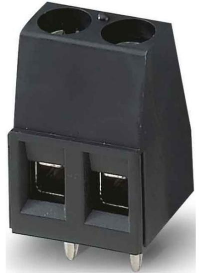
Phoenix Contact Leiterplattenklemme MKDS 1,5/ 2 #1985904 Höhe 13,8mm, Anzahl der elektrischen Anschlüsse 2, Anzahl der Etagen 1, Rastermaß der Anschlüsse 5,08mm, Winkel Leiterplatte/Leiteranschluss 0°/180° (horizontal),
