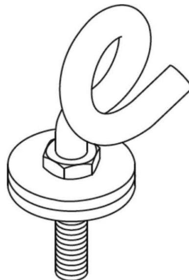
Pollmann Offene Ringschraube RS M5x50 Werkstoff Stahl, Oberfläche galvanisch/elektrolytisch verzinkt, Schaftlänge 50mm, Anschlussgewinde M 5, Offene Ringschraube mit je 2 Muttern und Unterlegscheiben Element zur Befestigung von Leuchten an Knotenkettten
