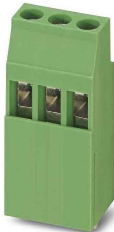
Phoenix Contact Leiterplattenklemme MKKDSH 3/ 3 Höhe 31,5mm, Anzahl der elektrischen Anschlüsse 3, Anzahl der Etagen 1, Rastermaß der Anschlüsse 5mm, Winkel Leiterplatte/Leiteranschluss 0°/180° (horizontal), Bemessungsstrom In 24A, Bemessungsspannung 400V, Bemessungsstoßspannung 4kV,
