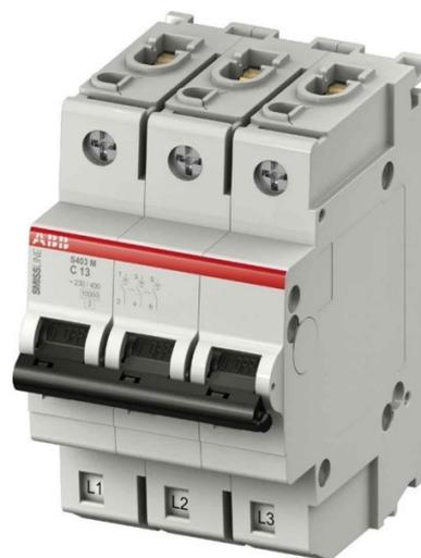
ABB Stotz S&J Leitungsschutzschalter 6A C 3p S403M-C6 Auslösecharakteristik C, Polzahl (gesamt) 3, Anzahl der abgesicherten Pole 3, Bemessungsstrom 6A, Bemessungsspannung 230V, Spannungsart AC, Energiebegrenzungsklasse 3, Frequenz 50 ...
