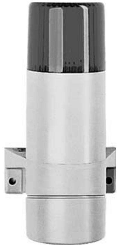
FHF Funke+Huster Blitzleuchte 230V AC rt 22415202 Nennspannung 230V, Stromart AC, Stromaufnahme 0,09A, Schutzart (IP) IP54, Werkstoff des Gehäuses Kunststoff, Leistung 5J, Kalottenfarbe rot, Montageart sonstige, Leuchtmittel Xenon, Optischer Signalgeber für Innen- und Außenmontage mit Ausgleichsventil zur Vermeidung von Kondenswasser, Temperaturbereich: -30°C bis +50°C
