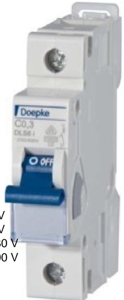
Doepke Leitungsschutzschalter DLS 6I C16-1 10 kA Auslösecharakteristik C, Polzahl (gesamt) 1, Anzahl der abgesicherten Pole 1, Bemessungsstrom 16A, Bemessungsspannung 230V, Bemessungsschaltvermögen Icn nach EN 60898 bei 230 V 10kA, Bemessungsschaltvermögen Icn nach EN 60898 bei 400 V 0kA, Bemessungsschaltvermögen Icu nach IEC 60947-2 bei 230 V 0kA, Bemessungsschaltvermögen Icu nach IEC 60947-2 bei 400 V 0kA, Spannungsart AC/DC, Energiebegrenzungsklasse 3, Frequenz 16,67 ...
