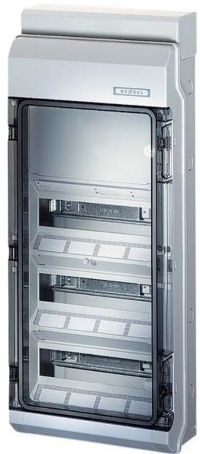
Hensel Automatengehäuse 3reihig KV 9440 Montageart Aufbau, Anzahl der Reihen 3, Breite in Teilungseinheiten 12, Ausführung Deckel geschlossen, Transparenter Deckel/Tür, Werkstoff des Gehäuses Kunststoff, Höhe 708mm, Breite 295mm, Tiefe 129mm, Einbautiefe 93mm, DIN-Schiene, Anbaumöglichkeit, Farbe grau, RAL-Nummer 7035, Schutzart (IP) IP65, Installationskleinverteiler nach IEC 60439-3, zum Einbau von Geräten mit Schnappbefestigung bis 63 A nach DIN 43880, schutzisoliert (Schutzklasse II).
