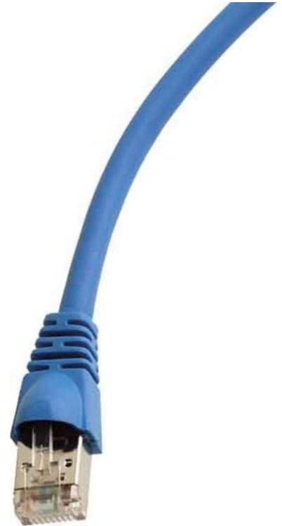
Telegärtner Patchkabel S/FTP 6A bl 3,0m 1x180Grd L0002A0115 Kabeltyp S/FTP, Kategorie 6A (IEC), Länge 3m, Steckverbindertyp Anschluss 1 RJ45 8(8), Steckverbindertyp Anschluss 2 RJ45 8(8), Mantel-Farbe blau, Knickschutztülle angespritzt, Rasthebelschutz, Farbe der Knickschutztülle blau, Ausführung flammwidrig, Halogenfrei, Kabelkonstruktion 4x2, AWG-Querschnitt 27, Pinbelegung 1:1, 360° Steckerabschirmung rundum geschlossen (geschirmte Kabel).
