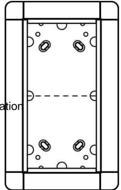
Ritto Portier UP-Rahmen tit 2-fach, 141x238mm 1881230 Anzahl der Einheiten 2, Werkstoff Stahl, Farbe sonstige, Montageart Unterputz, Höhe 239mm, Breite 141mm, Tiefe 57mm, Rahmen bestückbar mit 2 Portier Funktionsmodulen.
