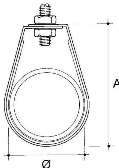
Niadax Rohrbefestigung PH-25 Geeignet für Rohrdurchmesser 25 ...
