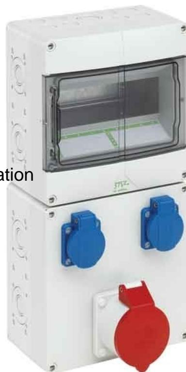
Spelsberg CEE-Steckdosen-Kombination STV 912-S32 CEE-Steckdose - 16 A ohne, CEE-Steckdose - 32 A 1x32A5p400V, CEE-Steckdose - 63 A ohne, CEE-Steckdose - 125A ohne, Anzahl der SCHUKO-Steckdosen 2, Absicherung ohne, FI-Schutzschalter ohne, Werkstoff des Gehäuses Kunststoff, Einspeisung/Anschlussmöglichkeit 2 Leitungen (Ringleitung/zum Durchschleifen), Handhabung Wandmontage, Schutzart (IP) IP44,
