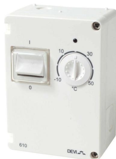
Devi Thermostat Leitungsfühler DEVIreg610 #140F1080 Ausführung Allzweckthermostat, Nennspannung 230V, Montageart Aufputz, Steuerleistung 2300VA, Schaltdifferenz 0,4K, Elektronische Regelung, Ein-/Ausschalter, Fühlerelement Leitungsfühler, Temperatur -10 ...
