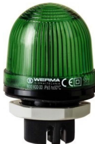
Werma Dauerleuchte 12-240V AC/DC gn 800.200.00 Nennspannung 240V, Stromart AC/DC, Leistung 5W, Schutzart (IP) IP65, Kalottenfarbe grün, Montageart Einbau, Fassung BA15d, Leuchtmittel Glühlampe, Manipuliersicher - Lampenwechsel erfolgt von hinten mit Bajonettverschluss, Mit Verdrehsicherung (als Zubehör), Mit Rohradapter auch als Aufbauleuchte verwendbar
