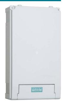
ABN Braun Hausanschlusskasten NH00, 50-185qmm HS864C Sicherung NH-Sicherung, Bemessungsstrom 200A, Anzahl der Gruppen 2, Werkstoff des Gehäuses Kunststoff, Höhe 720mm, Breite 410mm, Tiefe 190mm, Sicherheitsabdeckung, die nach Inbetriebnahme umgeklappt wird und als großflächige Berührschutzabdeckung im Gehäuse verbleibt
