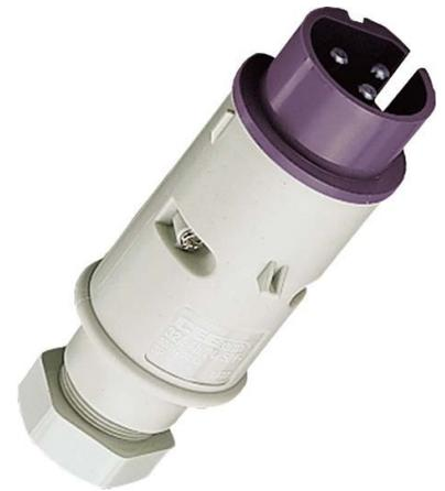
Mennekes Stecker 16A,2p,25V,IP44 655A IEC-Stromstärke 16A, Polzahl 2, Spannung nach EN 60309-2 20-25 V (50+60 Hz) violett, Kennfarbe lila/violett, Schutzart (IP) IP44, Anschlussstechnik Schraubklemme, Kabeleinführung Verschraubung, Steckrichtung gerade, Werkstoff Kunststoff,
