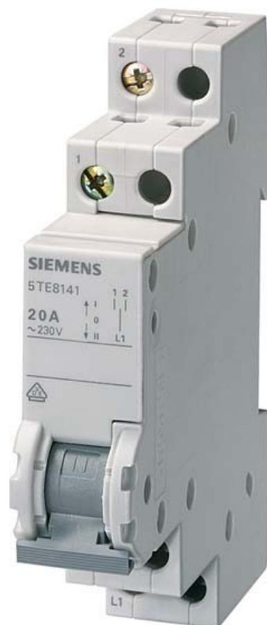
Siemens Indus.Sector Gruppenschalter 20A, 1Gruppe 5TE8141 Schaltfunktion Gruppenschalter, Anzahl der Schließer 0, Anzahl der Öffner 0, Anzahl der Wechsler 0, Bemessungsstrom 20A, Bemessungsspannung 230V, Bemessungsabschaltvermögen 0,06kA, Kurzschlussfestigkeit (Icw) 10kA, Spannungsart AC, Farbe der Kalotte nicht zutreffend, Leuchtmittel nicht zutreffend, Lampensockel nicht zutreffend, Breite in Teilungseinheiten 1, Einbautiefe 73,5mm, Schutzart (IP) sonstige, Gruppenschalter 20A 1 Gruppe
