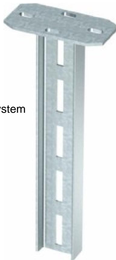
OBO Bettermann Vertr I-Stiel m.Kopfplatte 1100mm IS 8 K 110 FT Länge 1100mm, Profilbreite 80mm, Profilhöhe 42mm, Ausführung I-Profil, Werkstoff Stahl, Werkstoffgüte sonstige, Oberfläche tauchfeuerverzinkt, Farbe ohne, Hängestiel mit angeschweißter Kopfplatte.
