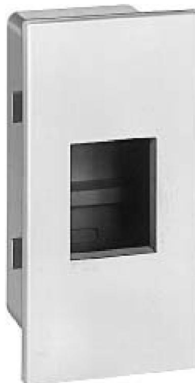
Siemens Indus.Sector Wandgehäuse IP40, Grau 5SW3007 Montageart Unterputz, Anzahl der Reihen 1, Breite in Teilungseinheiten 4,5, Ausführung Deckel mit Ausschnitt, Werkstoff des Gehäuses Kunststoff, Höhe 191mm, Breite 110mm, Tiefe 53mm, Einbautiefe 53mm, DIN-Schiene, Farbe grau, RAL-Nummer 9016, Schutzart (IP) IP40, Wandgehäuse, grau IP40, für Unterputzmontage für Einbaugeräte 4,5TE max.
