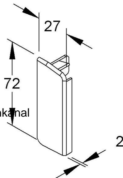
Kleinhuis Endstück rws Kanal-System SDK T/SFE70R.3 Höhe 72mm, Tiefe 27mm, Ausführung rechts, Dichtlippe Oberteil ohne, Werkstoff Kunststoff, Farbe reinweiß, RAL-Nummer 9010, Dekor ohne, Mit Teppichleiste,
