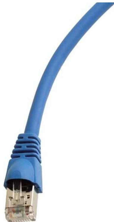
Telegärtner Patchkabel Cat5e 2,0m bl U/UTP,PVC L00001E0067 Kabeltyp U/UTP, Kategorie 5E, Länge 2m, Steckverbindertyp Anschluss 1 RJ45 8(8), Steckverbindertyp Anschluss 2 RJ45 8(8), Mantel-Farbe blau, Knickschutztülle angespritzt, Rasthebelschutz, Farbe der Knickschutztülle blau, Ausführung flammwidrig, Halogenfrei, Kabelkonstruktion 4x2, AWG-Querschnitt 24, Pinbelegung 1:1, Anschlussfolge nach EIA/TIA 568B.
