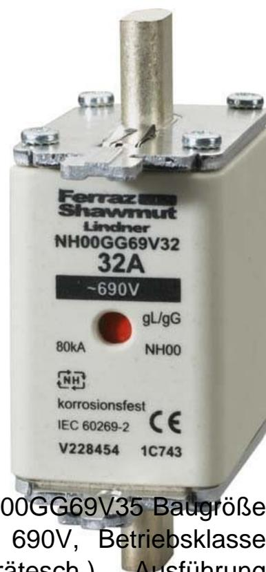
Mersen NH-Sicherungseinsatz Gr.00, 35A, 690V, GG NH00GG69V35 Baugröße NH00, Bemessungsstrom 35A, Bemessungsspannung 690V, Betriebsklasse gL/gG (Ganzbereichs-Leitungsschutz/Ganzbereichs-Gerätesch.), Ausführung Kennmelder Kombikennmelder,
