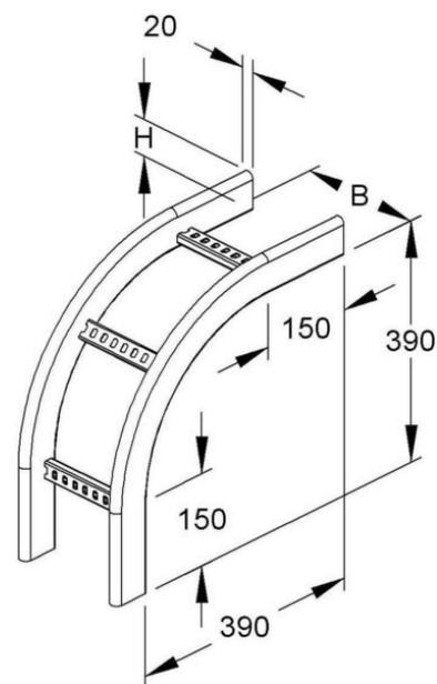
Niedax Fallstück KRCF 60.125 F Richtungsänderung vertikal fallend, Abiegung (Winkel) 90°, Innenradius 390mm, Ausführung des Seitenholms Röhrenform (geschlossen), Ausführung der Sprosse Profil gelocht, Kabelleiterhöhe 60mm, Kabelleiterbreite 100mm, Werkstoff Stahl, Werkstoffgüte sonstige, Oberfläche tauchfeuerverzinkt, Farbe ohne,
