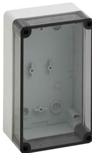
Spelsberg Leergehäuse TK PS 1811-8f-to Höhe 180mm, Breite 110mm, Tiefe 84mm, Einbautiefe 69mm, RAL-Nummer 7035, Anbaumöglichkeit, Werkstoff des Gehäuses Kunststoff, Oberfläche sonstige, Schutzart (IP) IP66, Art des Deckels transparent, IP 66, 180 x 110 x 137 mm, Leergehäuse  $U_i=690$  V, Kasten: Polystyrol, grau ähnlich RAL 7035 Deckel: Polycarbonat, transparent
