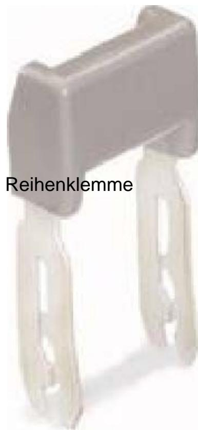
WAGO Kontakttechnik Schachtelbrücker 1 auf 6 781-456 Ausführung Schachtelverbinder, Anzahl der gebrückten Klemmen 2, Explosionsgeprüfte Ausführung Ex e, Bemessungsstrom In 32A, Bemessungsspannung 400V, Isoliert, Mit Berührungsschutz, Montageart steckbar, Rastermaß 6mm, Farbe grau,
