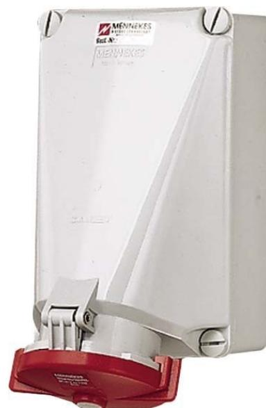
Mennekes Wanddose HW/VN 125A,5p,6h,400V,IP67 21468 Ausführung Aufputz, IEC-Stromstärke 125A, Polzahl 5, Spannung nach EN 60309-2 400 V (50+60 Hz) rot, Uhrzeit-Stellung 6h, Kennfarbe rot, Schutzart (IP) IP67, Anschlussstechnik Schraubklemme, Werkstoff Kunststoff, Befestigungsart innenliegende Befestigung,
