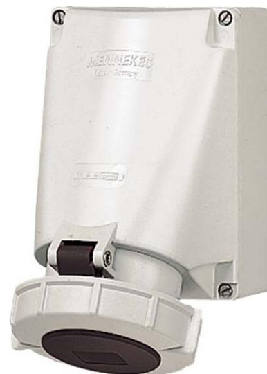
Mennekes Wanddose 63A,4p,7h,500V,IP67 133P Ausführung Aufputz, IEC-Stromstärke 63A, Polzahl 4, Spannung nach EN 60309-2 500 V (50+60 Hz) schwarz, Uhrzeit-Stellung 7h, Kennfarbe schwarz, Schutzart (IP) IP67, Anschlussstechnik Schraubklemme, Werkstoff Kunststoff, Befestigungsart innenliegende Befestigung,
