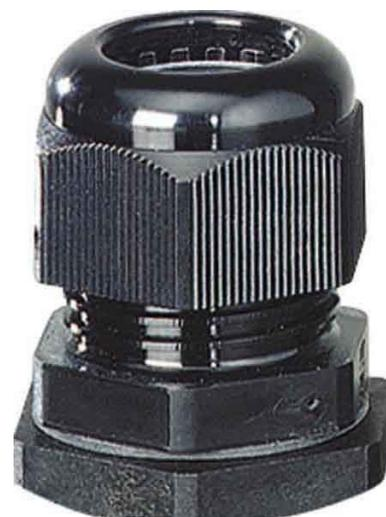
Hensel Anbaukabelstutzen IP67 M16 ASS 16 Gewindeart metrisch, Gewindenengröße metrisch/PG 16, Gewindenengröße in Zoll NPT/Gasrohrgewinde sonstige, Gewindesteigung 1,5mm, Gewindelänge 8mm, Schlüsselweite 20mm, Sechskant Eckmaß 22mm, Für Kabeldurchmesser 3 ...
