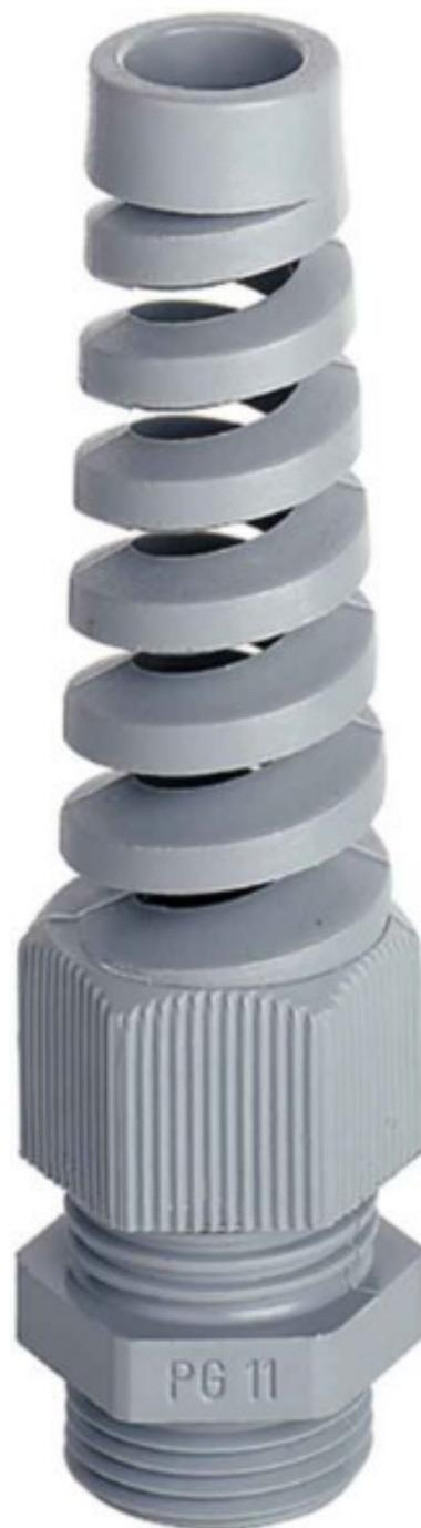
Jacob PA-Kabelverschraubung Polyamid PG11 50.011 PA/BS Gewindeart PG, Gewindenenngröße metrisch/PG 11, Gewindelänge 8mm, Schlüsselweite 22mm, Für Kabeldurchmesser 5 ...
