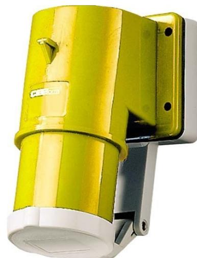
Mennekes Aufbaustecker 16A,4p,4h,110V,IP44 392 IEC-Stromstärke 16A, Polzahl 4, Spannung nach EN 60309-2 110 V (50+60 Hz) gelb, Uhrzeit-Stellung 4h, Kennfarbe gelb, Schutzart (IP) IP44, Anschlussstechnik Schraubklemme, Bauform Aufbaugerätestecker, Steckrichtung rechtwinklig, Werkstoff Kunststoff,
