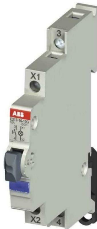
ABB Stotz S&J Leuchttaster gelb E217-16-01E Anzahl der Öffner 1, Anzahl der Schließer 0, Anzahl der Wechsler 0, Schaltstrom 16A, Schaltspannung 250V, Spannungsart AC/DC, Mit Signallampe, Farbe der Kalotte gelb, Leuchtmittel LED, Lampensockel sonstige, Max.
