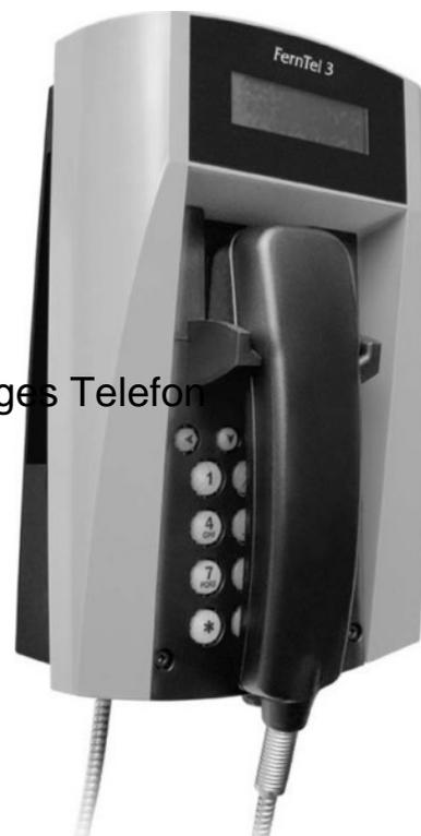
FHF Funke+Huster Telefon o.Display Panzerschnur sw/rt 11232022 Ausführung Standard, Mobilteile anmeldbar 0, Display ohne, Geeignet für Wandmontage, Gehäuse aus schlagfestem Kunststoff (Polycarbonat), 3 Schutzart IP 65 nach IEC60529, 3 optional Handapparat fest arretierbar (Schlingerhalterung), 3 Umgebungstemperatur -25°C bis +55°C, 3 Rufton .
