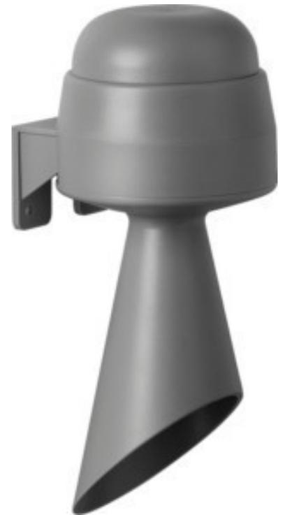
Werma Signalhupe 115V AC 584.000.67 Gehäusefarbe grau, Werkstoff des Gehäuses Kunststoff, Lautstärke 98dB, Nennspannung 115V, Schutzart (IP) IP65, Stromart AC, Stromaufnahme 0,07A, Wartungsfreie elektronische Hupe mit einer Lebensdauer von bis zu 5.000 h, Integrierter Winkel für einfache Wandmontage ohne zusätzliches Zubehör
