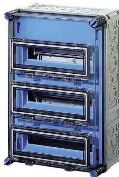
Hensel Automatengehäuse 36TE Mi 1337 Montageart Aufbau, Anzahl der Reihen 3, Breite in Teilungseinheiten 12, Ausführung Deckel geschlossen, Transparenter Deckel/Tür, Werkstoff des Gehäuses Kunststoff, Höhe 450mm, Breite 300mm, Tiefe 185mm, Einbautiefe 93mm, DIN-Schiene, Anbaumöglichkeit, Farbe grau, RAL-Nummer 7032, Schutzart (IP) IP65, Isolierstoffgekapselte Niederspannungs-Schaltanlage in Kastenbauform als \"Typgeprüfte Schaltgeräte-Kombination\" TSK nach IEC 60 439 -1 für Wandaufbau.
