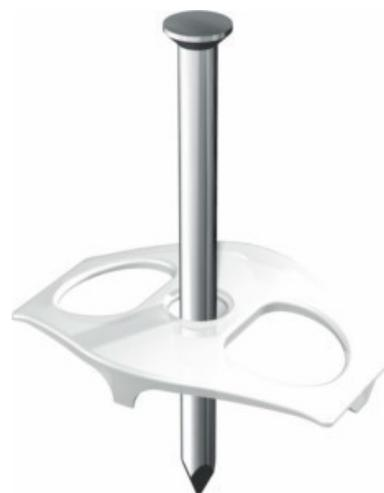
OBO Bettermann Vertr Nagel-Fix m.Nagel 3,5x60,Iso,natur 1996 60 Nagellänge 60mm, Nageldurchmesser 3,5mm, Anzahl der Leitungen NYM 3x1,5 2, Werkstoff Scheibe Kunststoff, Werkstoff Nagel Stahl, Oberfläche galvanisch/elektrolytisch verzinkt, Farbe natur, Mit Nagel, Zur Fixierung von Leitungen in Mauerschlitzen und auf Mauerwerk.
