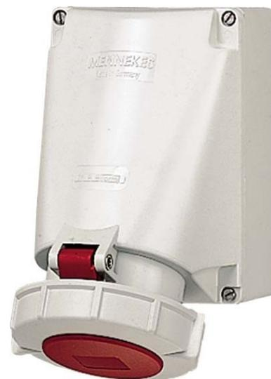
Mennekes Wanddose 63A,5p,6h,400V,IP67 136P Ausführung Aufputz, IEC-Stromstärke 63A, Polzahl 5, Spannung nach EN 60309-2 400 V (50+60 Hz) rot, Uhrzeit-Stellung 6h, Kennfarbe rot, Schutzart (IP) IP67, Anschlussstechnik Schraubklemme, Werkstoff Kunststoff, Befestigungsart innenliegende Befestigung,
