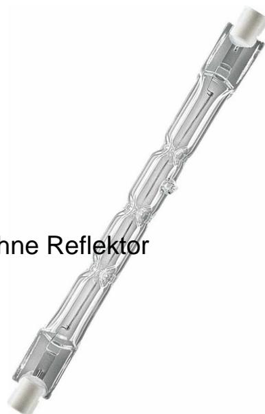
Osram Haloline-Lampe 750W 230V R7s-p15 64560 Lichtstrom 16500lm, Mittlere Nennlebensdauer 2000h, Energieeffizienzklasse C, Lampenleistung 750W, Sockel R7s, Lampenform Röhre, zweiseitig gesockelt, Durchmesser 12mm, Gesamtlänge 191,1mm, Ausführung klar, Farbtemperatur 3000K, Gewichteter Energieverbrauch in 1000 Stunden 750kWh, Brillantes Halogenlicht, ideal zur Betonung und Akzentuierung der Raumstruktur, 100 % dimmbar, vielseitig einsetzbar, einfach an Netzspannung ohne Trafo zu betreiben.
