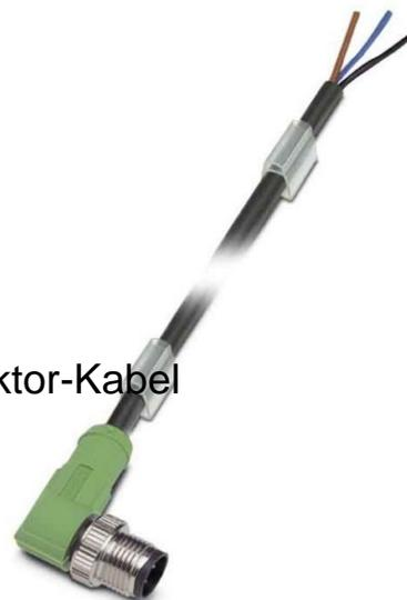
Phoenix Contact Sensor-/Aktor-Kabel SAC-3P-M12MR/1,5-PUR Polzahl 3, Ausführung elektrischer Anschluss, feldseitig freies Leitungsende, Art des Steckkontaktes, feldseitig Male (Stecker), Anordnung der Kabelzuführung, feldseitig sonstige, Ausführung elektrischer Anschluss, gehäuseseitig M12, Art des Steckkontaktes, gehäuseseitig Male (Stecker), Anordnung der
