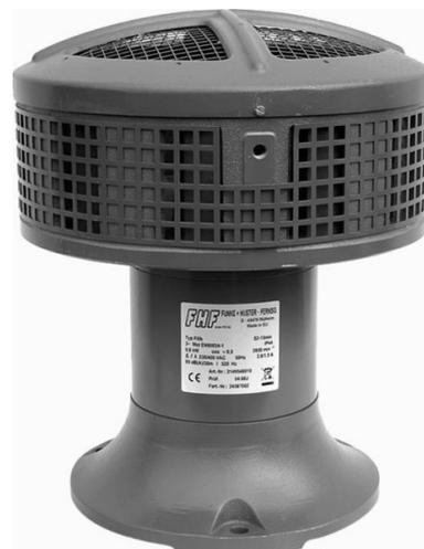
FHF Funke+Huster Motor Sirene 380/400V AC 2149548010 Gehäusefarbe grau, Werkstoff des Gehäuses Metall, Lautstärke 123dB, Stromart AC, Schutzart (IP) IP22, Stromaufnahme 2,6A, Alarm und Signalgeber für Innen und Außenbereich
