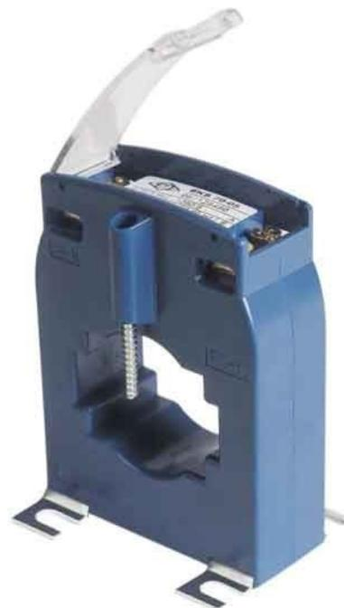
NZR Aufsteckstromwandler K.1 ungeeicht 400/5A 42031442 Ausführung Durchsteckstromwandler, Primärer Bemessungsstrom In 400A, Sekundärer Bemessungsstrom 5A, Sekundäre Bemessungsscheinleistung 5VA, Genauigkeitsklasse 1, Mit Berührungsschutz, Öffnungshöhe 18mm, Öffnungsbreite 30mm, Öffnungsdurchmesser 25mm, Sekundäranschluss Schraubanschluss, Anzahl der Primäreingänge 1, Stromwandler für Niederspannung, Prüfspannung 720 V, Temperaturbereich von -25 bis +55°C, Schutzklasse IP 50
