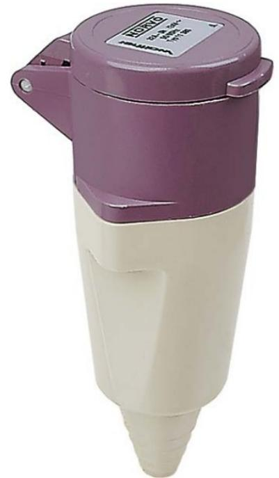
Walther Werke NORVO Kupplung 16A 2P 24V 0h IP44 10380 IEC-Stromstärke 16A, UL/CSA-Stromstärke (wenn UL-Ausführung gewünscht) 20A, Polzahl 2, Spannung nach EN 60309-2 20-25 V (50+60 Hz) violett, Uhrzeit-Stellung 0h, Kennfarbe lila/violett, Schutzart (IP) IP44, Anschlussstechnik Schraubklemme, Steckrichtung gerade, Kabeleinführung Knickschutztülle, Werkstoff Kunststoff, NORVO Kupplung 16A 2P 24V IP44 mit Kabelknickschutz
