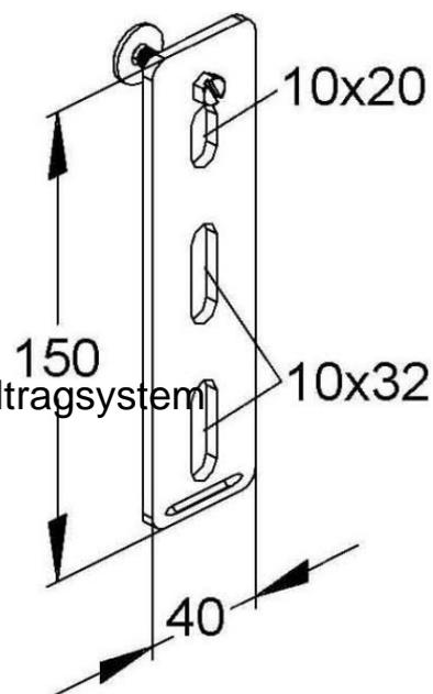
Niedax GK-Nivellierplatte GNP 15 Werkstoff Stahl, Werkstoffgüte sonstige, Oberfläche galvanisch/elektrolytisch verzinkt, Farbe ohne, Nivellierplatte, zum Ausrichten der Wandkonsolen auf schrägen Wänden, bis 15 mm
