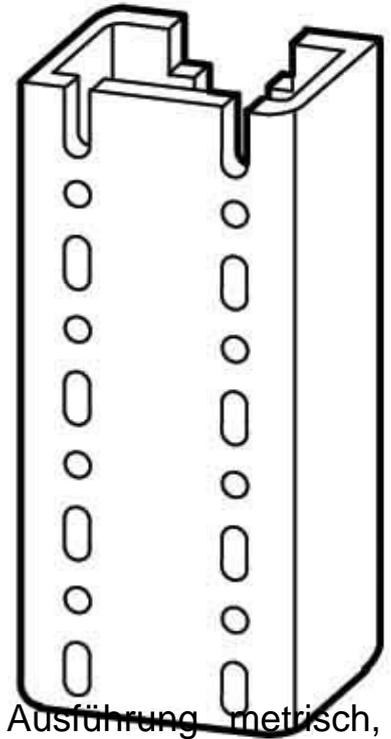
Eaton (Moeller) Tragrahmenprofil senkrecht WS6-ID Ausführung metrisch, Werkstoff Stahl, Ausführung der Oberfläche verzinkt, Montageart Schraubbefestigung, Profil für Tragrahmen CI, für Wandverteiler, Standverteiler oder Wandverteiler am Boden abgestützt, Stahl verzinkt und passiviert, C-Profil mit Stanzungen im Abstand von 25mm, Verbindungsstücke und Befestigungsschrauben sind separat erhältlich
