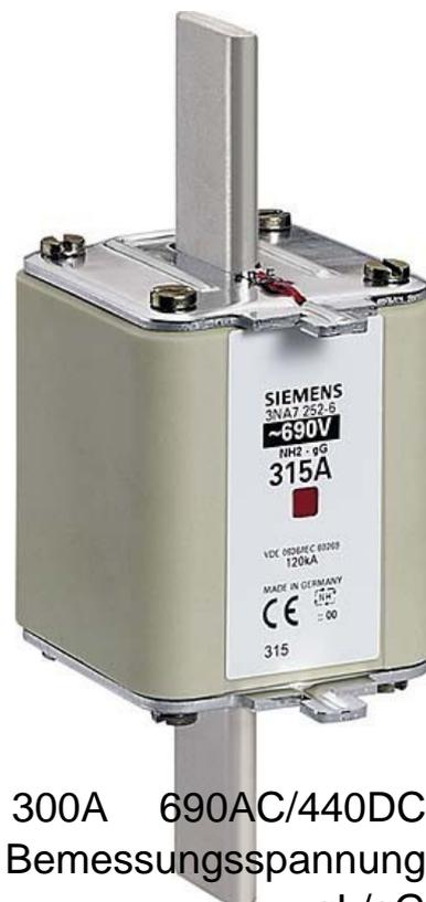
Siemens Indus.Sector NH-Sicherungseinsatz Gr2 300A 690AC/440DC 3NA7250-6 Baugröße NH2, Bemessungsstrom 300A, Bemessungsspannung 690V, Betriebsklasse gL/gG (Ganzbereichs-Leitungsschutz/Ganzbereichs-Gerätesch.), Ausführung Kennmelder Kombikennmelder, NH-Sicherungseinsätze gibt es in folgenden Betriebsklassen: gG für den Kabel- und Leitungsschutz, aM für den Kurzschlusschutz von Schaltgeräten in Motorenstromkreisen, gR bzw.
