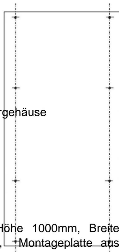
ABN Braun PVC-Montageplatte AS-205 SY47436M Höhe 1000mm, Breite 500mm, Werkstoff Kunststoff, Oberfläche unbehandelt, ~~Montageplatte aus~~ selbstverlöschenden Kunststoff, 6 mm stark
