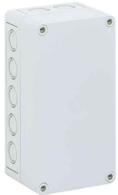
Spelsberg Leergehäuse TK PS 1809-8-m Höhe 180mm, Breite 94mm, Tiefe 81mm, Einbautiefe 69mm, RAL-Nummer 7035, Werkstoff des Gehäuses Kunststoff, Schutzart (IP) IP66, Leitungseinführung, Art des Deckels geschlossen, Leergehäuse, Bemessungsisolationsspannung 690 V, aus Polystyrol.
